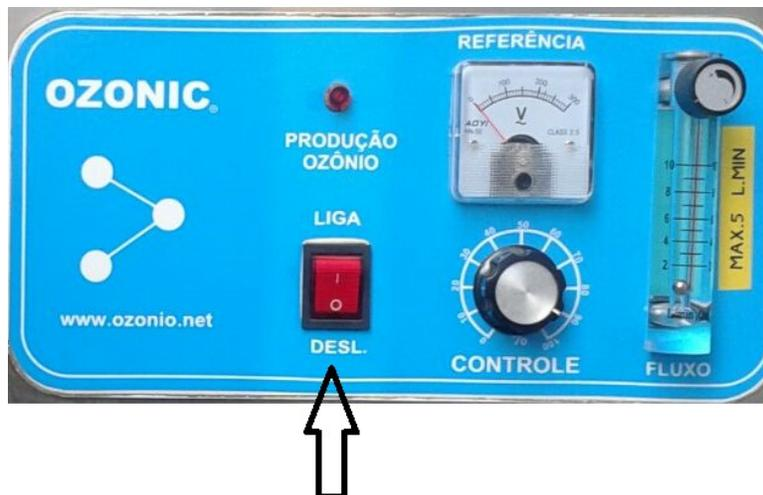
5 – ajuste o fluxômetro em 6 litros por minuto.
